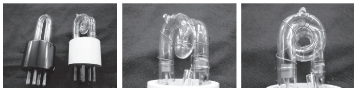
電極間の距離を取るために、屈折や螺旋状の形をしている
