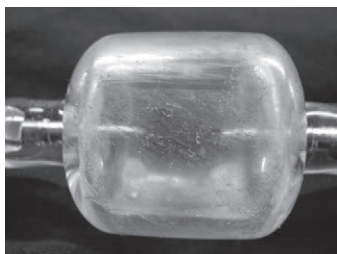
封入された金属化合物が管球の内側に固形化されている。点灯すると気化して透明になる
