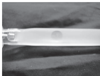
真ん中の窓までモリブデン箔が変色してきたら寿命が近い
